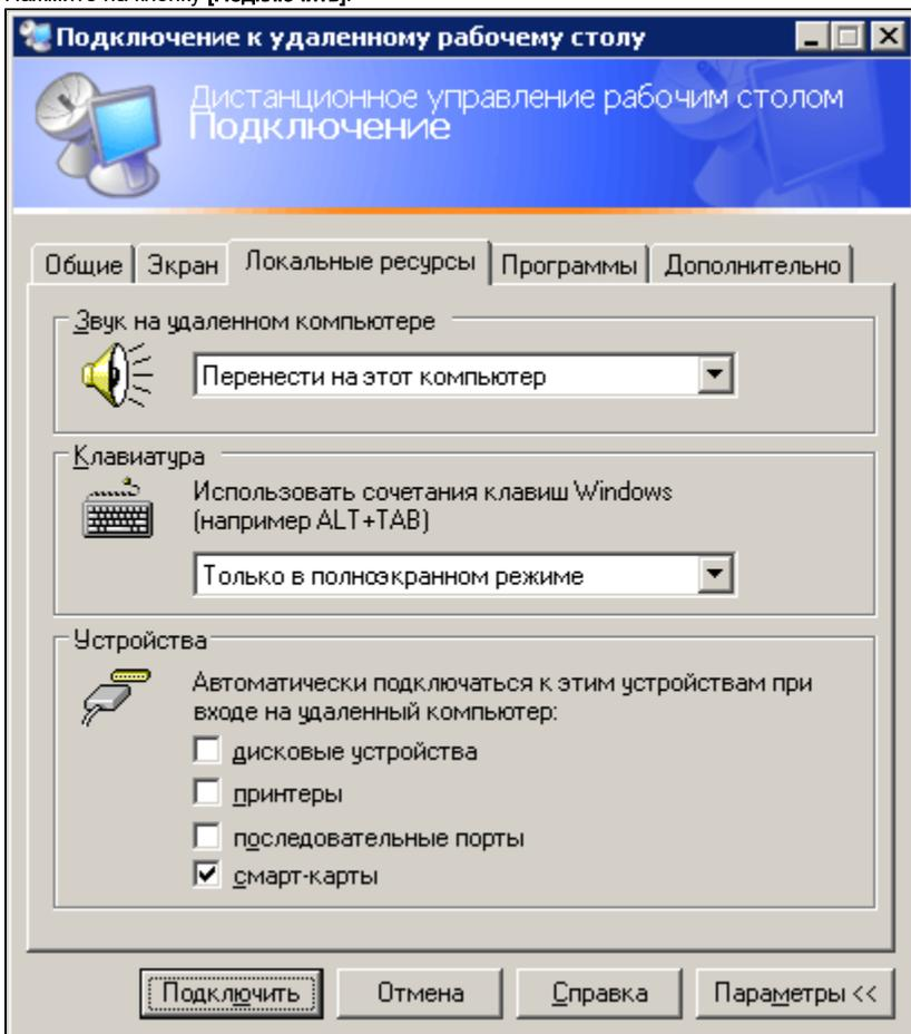
Если в системе не установлены драйверы Рутокен, эта настройка в окне **Подключение к удаленному рабочему столу** отсутствует.
